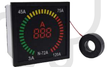
Amperímetro análogo/digital 3-120ACA Alimentación - Precisión: 2% Medidas: 73 x73 x 52mm Perforación: 67 x67mm
