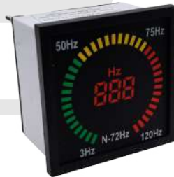
Frecuenciómetro análogo/digital 3-120hz Alimentación - Precisión: 2% Medidas: 73 x73 x 52mm Perforación: 67 x67mm
